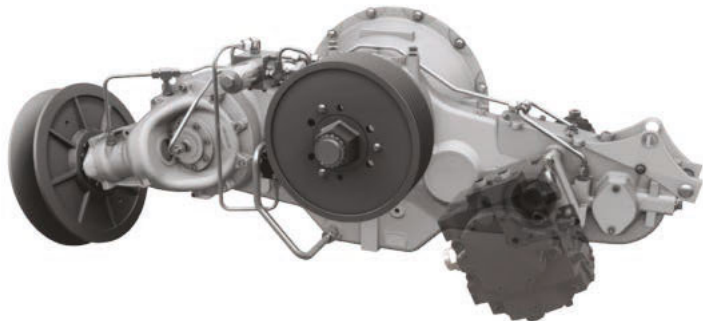
O novo DriveCenter cria uma função de trem de acionamento altamente eficiente. Os principais componentes da máquina, como o processador de hélice, o sistema de limpeza, a mesa e as bombas hidráulicas são acionados para um melhor efeito através de uma conexão direta com o motor.
