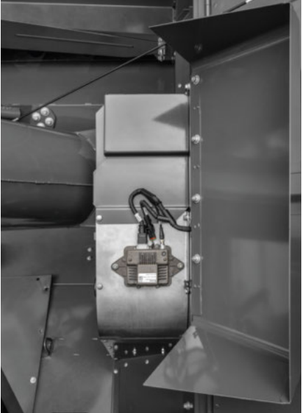
Uma boa visão global do rendimento, humidade e qualidade é sempre fornecida graças aos dados em tempo real do campo: Sensores para rendimento e humidade, bem como câmara com qualidade para os grãos, são montados no elevador. Os dados têm uma precisão de 98% e são utilizados graças ao padrão VarioDoc ISOBUS, mapeamento de produção ao vivo e IDEALharvest™.
