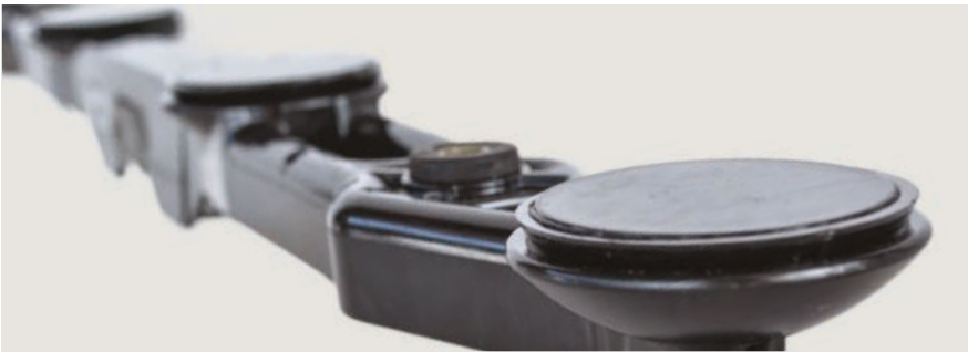
Os sensores de perda no final da sapata vibratória ajudam o operador a ajustar a máquina na melhor configuração possível, registrando a cultura que cai ao solo através de pressão e acústica.
